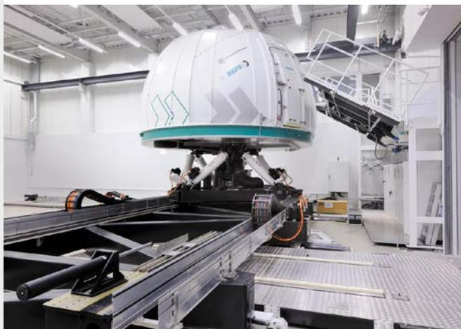
Des amortisseurs de sécurité d'ACE protègent les positions finales de deux axes d'un simulateur de conduite
