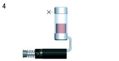
Rappel par ressort avec réservoir air/huile. Aucune alimentation en air branchée. Remarque : allongera le temps de retour.
