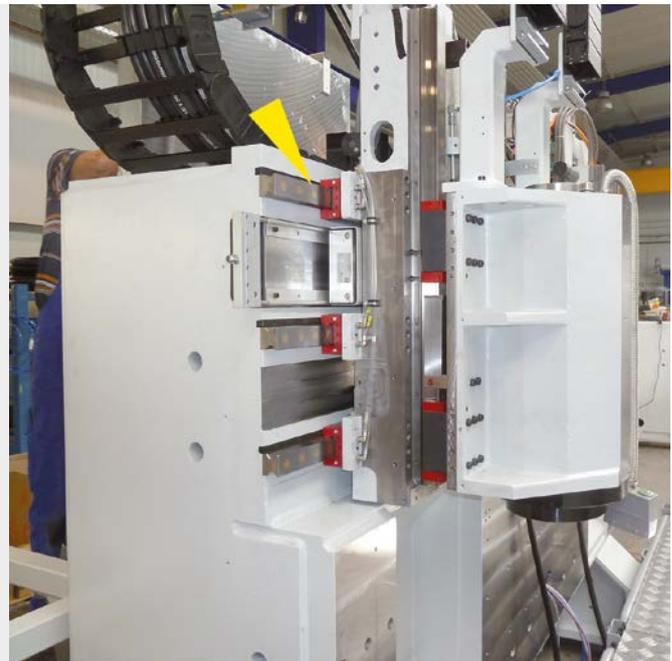
Les éléments de sécurité et les bloqueurs d'ACE assurent un maintien extrêmement solide sur les axes dans des tours spéciaux et respectent les positions prédéterminées horizontalement et verticalement
