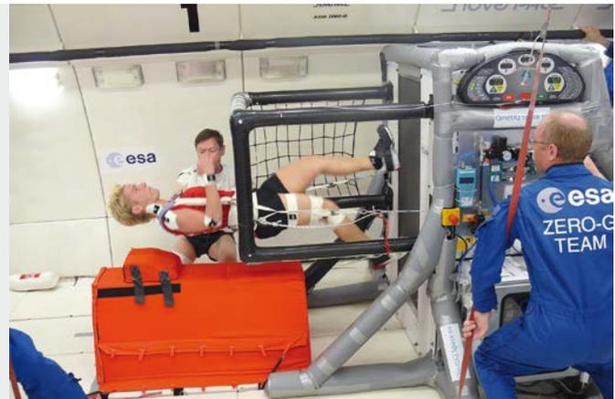
Les TUBUS sont utilisés pour protéger une machine de remise en forme en apesanteur
