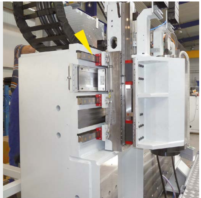
Klem- en veiligheidselementen van ACE houden assen in de speciale draaibank rotsvast op hun plaats en zorgen ervoor dat de eerder vastgelegde standen in zowel horizontale als verticale richting gehandhaafd blijven RASOMA Werkzeugmaschinen GmbH, 04720 Döbeln, Duitsland
