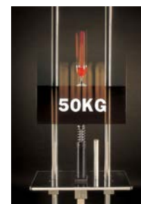
Vrije val van een wijnglas van 1,3 m hoogte. Afremming door een stootdemper, zonder een druppel te morsen.
