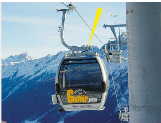
Hydraulische remcilinders verhogen het comfort bij ritten in een kabelbaan
