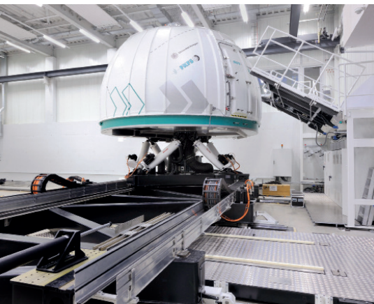
02 Im Notfall bremsen die Sicherheitsstoßdämpfer die Energie von bis zu 18 t bei einer maximalen Geschwindigkeit von 2 m/s in der Endlage der am stärksten beanspruchten Achse des Stuttgarter Fahrsimulators ab
