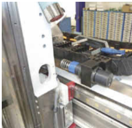
Zudem dienen zwei Sicherheitsdämpfer der SCS-Serie von ACE in den Endlagen der Linearmodule als Überfahrerschutz
